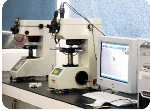
현미경 경도 검사 장비는 각 공정별로 공차내의 경도를 확보하기 위해 사용 되어 집니다.
