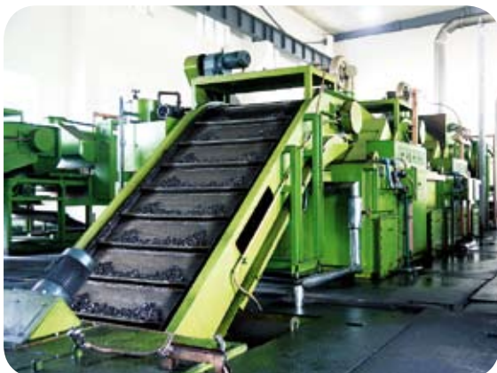
이송 가열로 라인은 롤러와 부싱의 열처리 즉 침탄 질화 열처리에 사용 됩니다.
